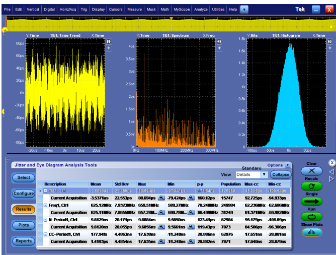
ジッタ解析 - 622Mbps 信号の TIE ジッタ／時間解析
