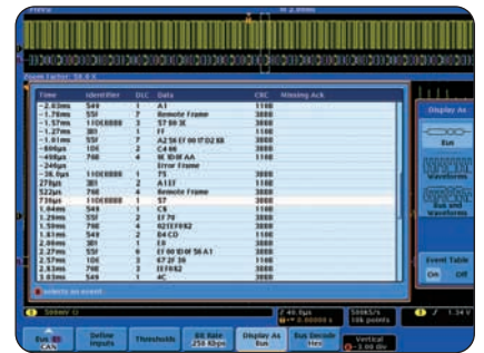
▶ パケット・デコード・テーブルの表示例（各CANパケットにおけるデコードされた識別子、DLC、データ、CRCを一覧表示）
