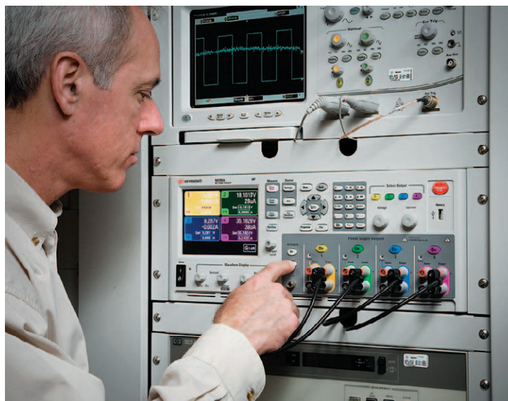
図14. N6705は標準の19インチ・ラックに収納することができます。
