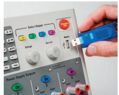
図12. N6705フロント・パネルのUSBポート。
