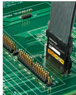
P6960型基板接続例
