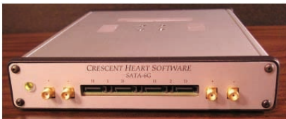
SATA-6GシリアルATAバス・アナライザ (Crescent Heart Software社製)
