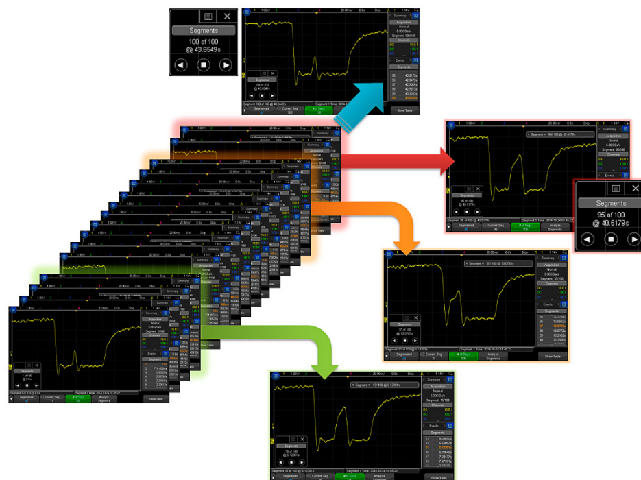
図13. セグメントメモリにより、さまざまなタイプのグリッチが発生していることがわかります。
