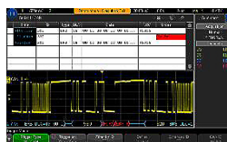
図17. CAN-FD デコードおよびトリガ
