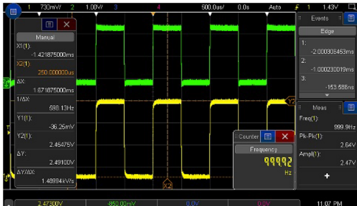
図3. サイドバーは、移動可能なドッキングパネルで、画面上の目的の場所に情報を表示可能。
