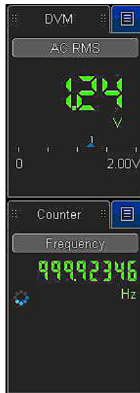
図25. DVMとカウンターでは、オシロスコープのプローブを使用して、トリガなしに信号を測定することができます。
