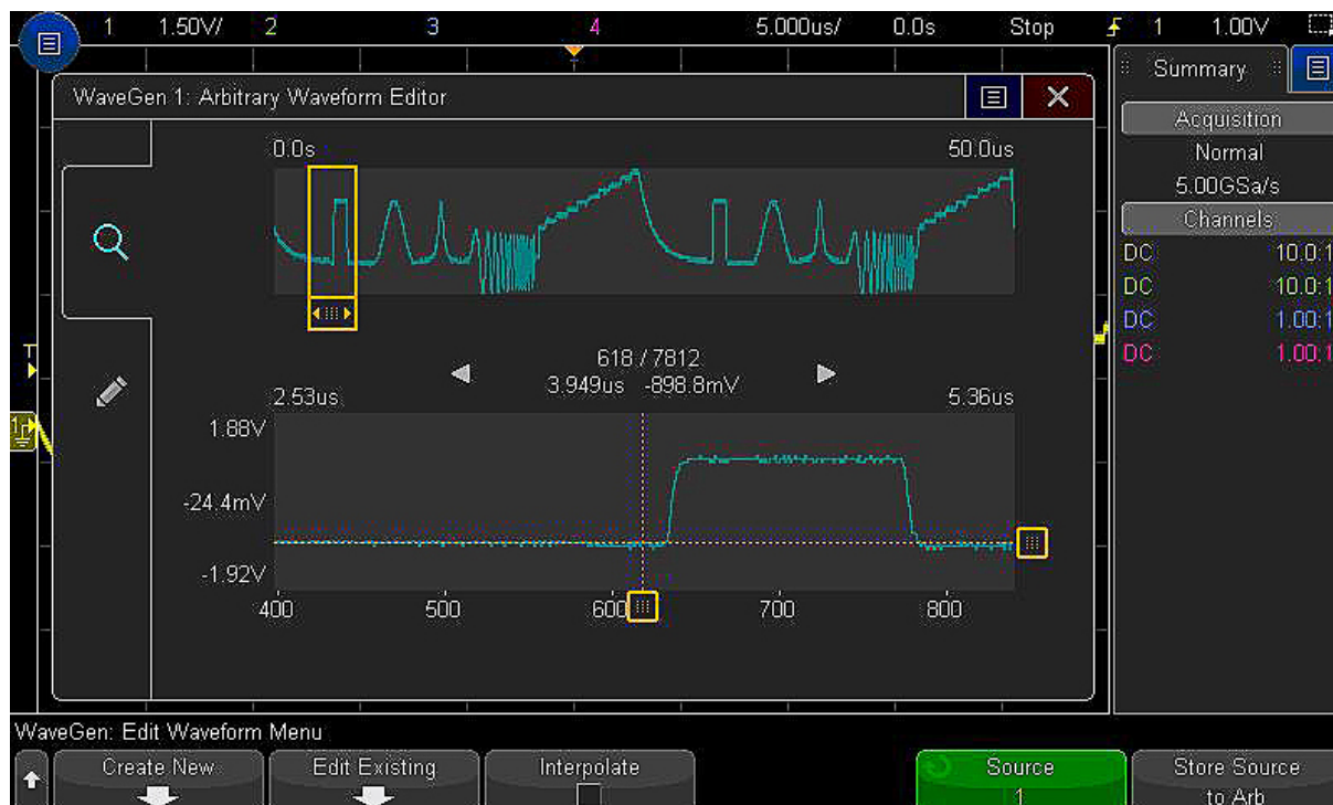
図24. オプションの任意波形発生器で、入力信号に簡単にアクセスできます。内蔵の任意波形発生器を使用すれば、信号を簡単に捕捉／変更／再生できます。
