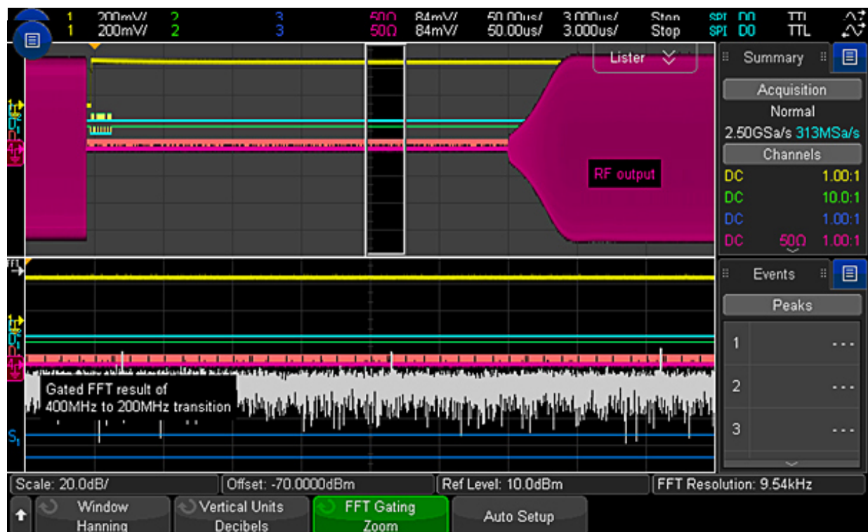
図21a SPIコマンドでトリガされたRF信号は、リスターに示されているように、400 MHzのままです。
