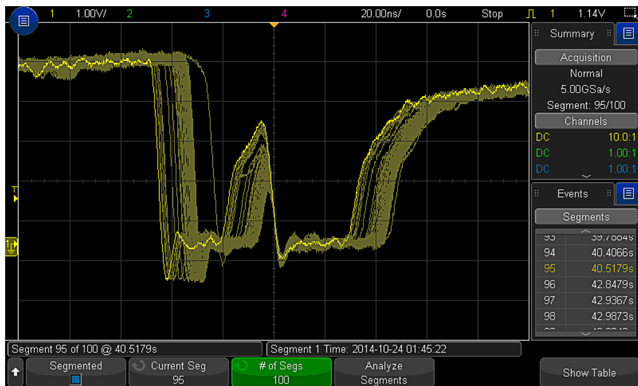
図13a ワーストケースの波形解析のために100個のセグメントがすべて重ね書きされた画面表示。
