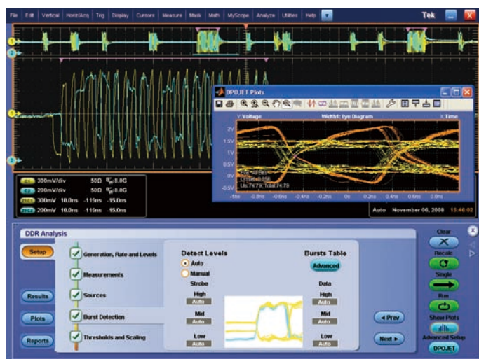
DDRメモリ・バス解析 (Opt. DDRA) — DDR1、LP-DDR1、LP-DDR2、DDR2、DDR3、GDDR3のリード／ライトを自動的に識別し、すべてのリード／ライト・バーストにおいてJEDEC適合性測定を行い、パス／フェイル結果を表示する。また、クロック、アドレス、コントロール信号も測定できる。さらに、DPOJETでDDRAの適合性試験を実行することで、複雑なメモリ信号問題をすばやく解決する。16チャンネルのデジタル・ロジック・ブローピングが可能なMSO70000Cシリーズ・ミックスド・シグナル・オシロスコープでは、コマンド／アドレス・ラインを使って特定のリード／ライト・ステートにトリガしたり、リード／ライト識別にも利用したりすることができる
