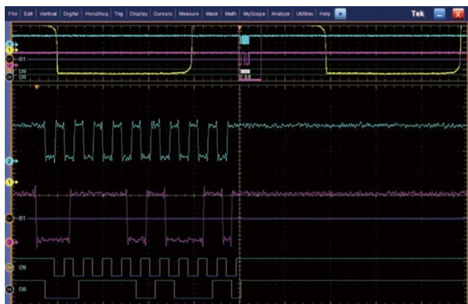
ロジック・チャンネルの統合 — システム・デバッグにおけるアナログとデジタルの相関関係ととれる
