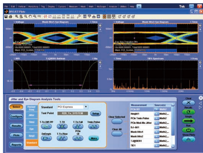
PCI Expressコンプライアンス・テスト・ソリューション (Opt. PCE/PCE3) — 総合的なテスト・サポートにより、PCI-Express Rev 1.0、2.0、3.0（ドラフト仕様）の設計性能を解析する。DPOJETの使用により、PCI-SIGの適合性をテストできる
