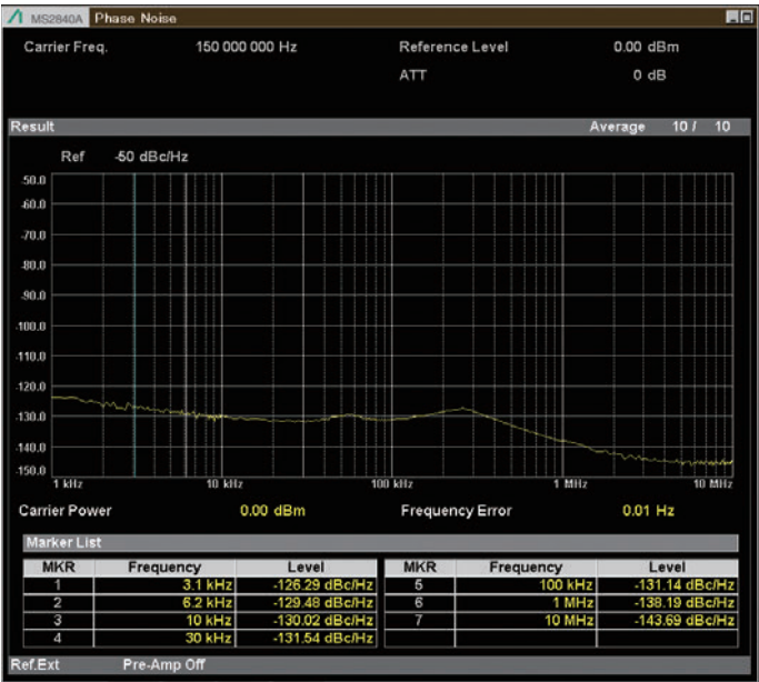
位相雑音測定 測定周波数 150MHz、プリアンプ Off
