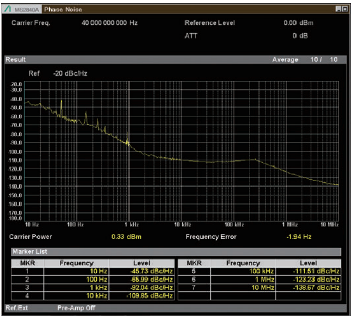
位相雑音測定 測定周波数 40GHz、プリアンプ Off
