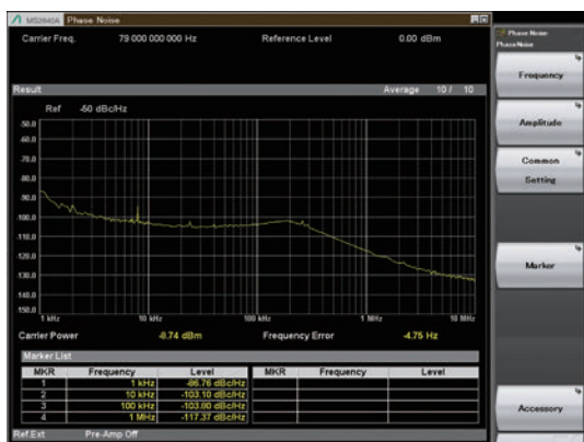
位相雑音測定 測定周波数 79 GHz (高性能導波管ミキサ MA2808Aを使用)
