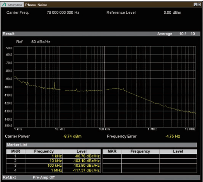
位相雑音測定 測定周波数 79GHz(高性能導波管ミキサ MA2808Aを使用)
