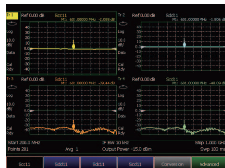
ミックスドモードSパラメータ測定によるコモンモード反射と差動モード反射の特性評価
