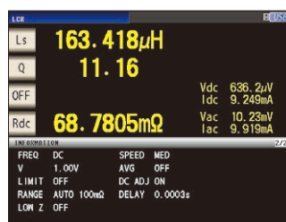
L、Q、Rdc 連続測定画面 L、Q(1 kHz,CC1 mA測定)と Rdc(DC測定)の表示画面
