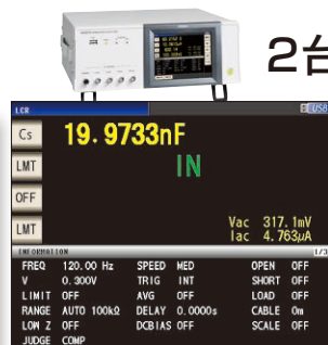
LCR モード Cs 表示画面(1 kHz 測定)
