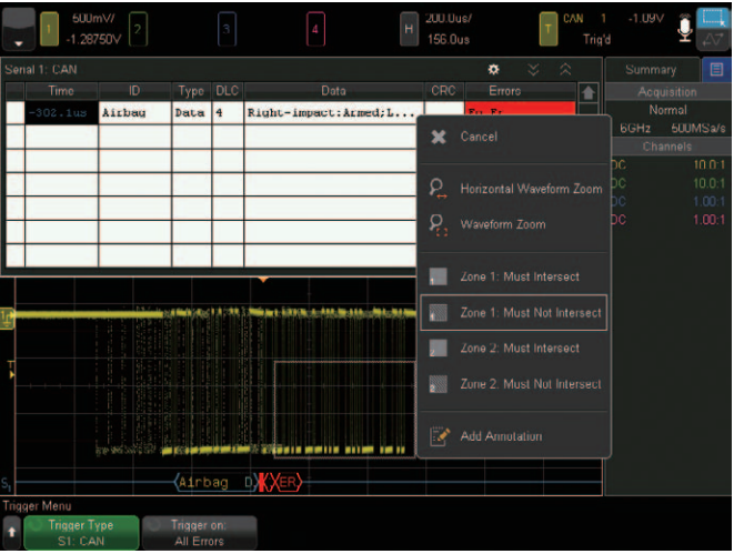
図13. CANバス・エラー・パケット・トリガに加えて、InfiniiScanゾーントリガを設定します。
