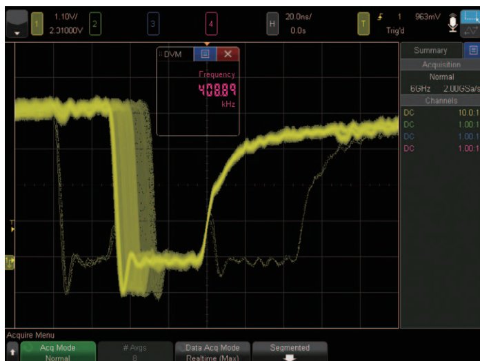
図10. 6000 Xシリーズは波形更新レートが超高速なので、発生頻度の低いグリッチも検出できます。
