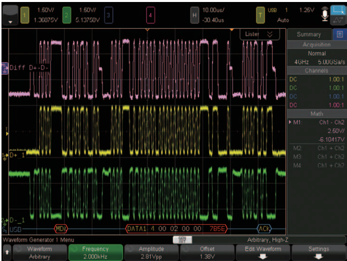
図29. デュアルチャンネル波形発生器による差動信号の出力。
