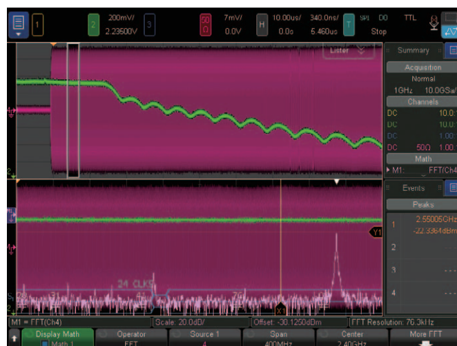
図37a. ゲーティッドFFTによる、与えられたタイムスパンのPLL電圧、SPIコマンド、スペクトラム成分の時間相関。
