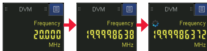
図33. 高精度の10桁カウンターにより、クロックの真の周波数が20 MHzにほんのわずかな足りないことがわかります。
