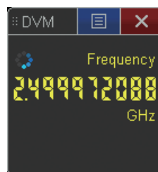
図32. 10桁カウンターによる2.5 GHz信号の正確な周波数測定。
