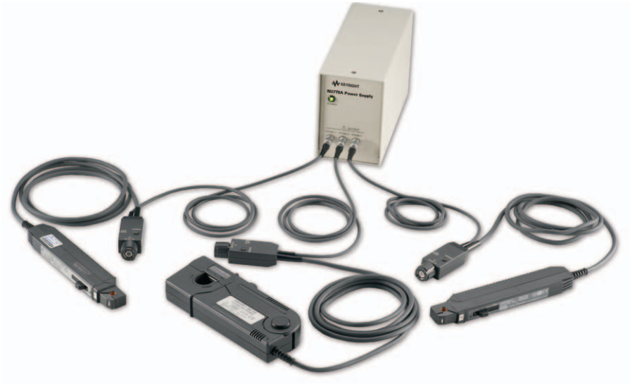
N2780Bシリーズ 電流プローブとN2779A電源
