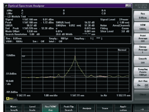
積分法による光レベル測定が有効なスペクトラム例
