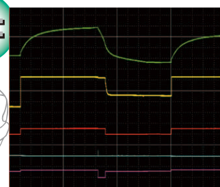
● バッテリーの評価 (制御信号と充放電時間の測定例)
