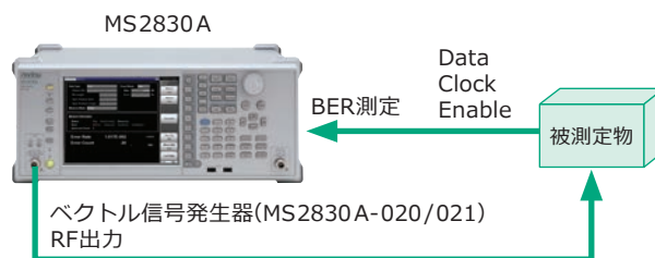
BER測定セットアップ例(MS2830A-020/021搭載時)
