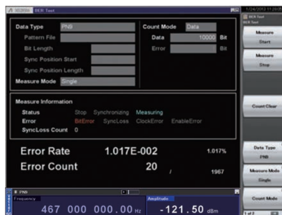
BER測定機能(上側)とベクトル信号発生器(下側)の測定例
