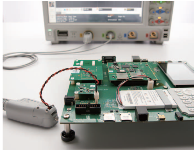
図1. キーサイトの超高感度N2820A/N2821A電流プローブ(最小分解能50 \mu A)は、バッテリー駆動デバイスに多く見られる低い電流レベルを測定できます。
