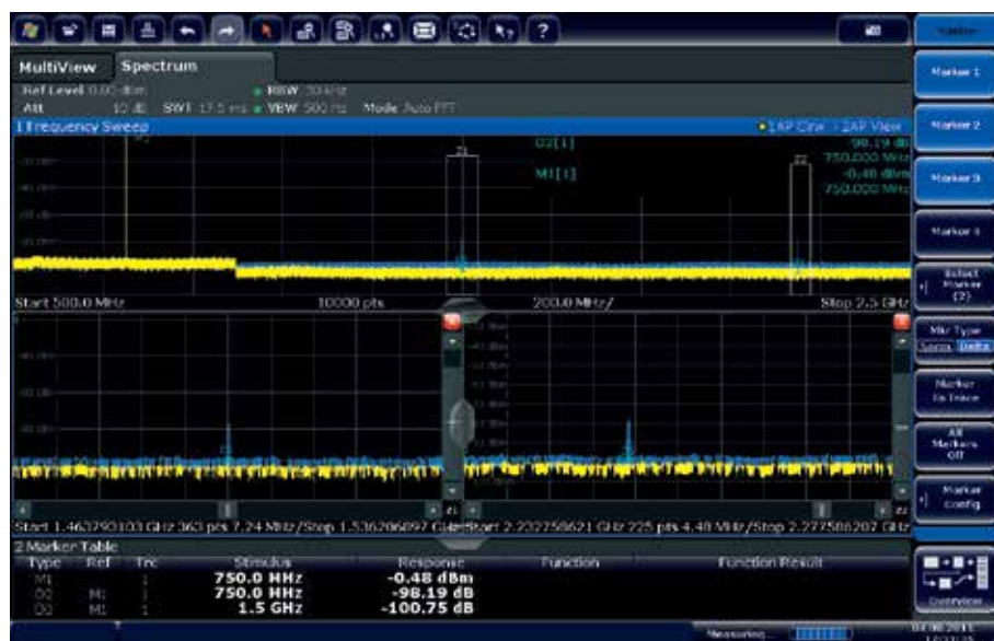
高調波の測定: トレース 1 (黄色) は、ハイパス・フィルタ有効での測定値で、トレース 2 (青色) は、ハイパス・フィルタ無効での測定値です。
