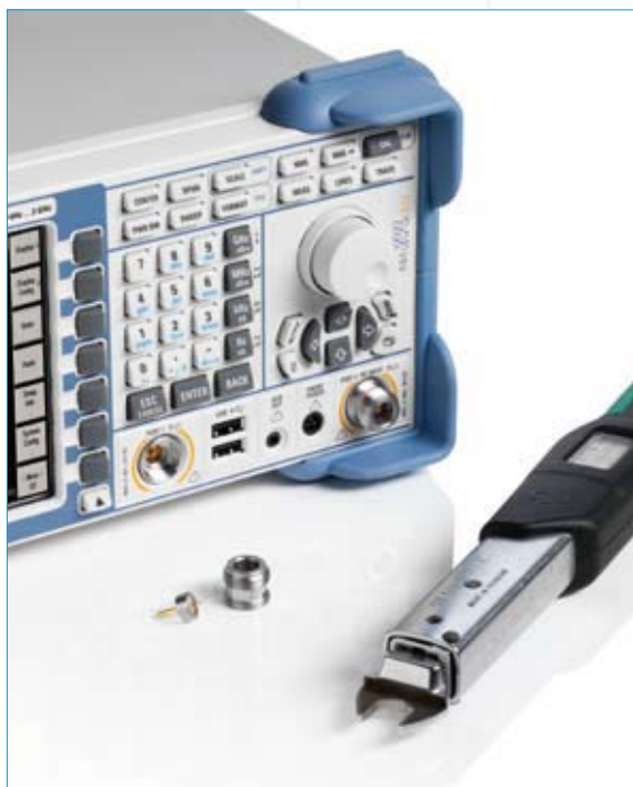
R&S®ZVL3/75 の破損したコネクタの容易な交換
