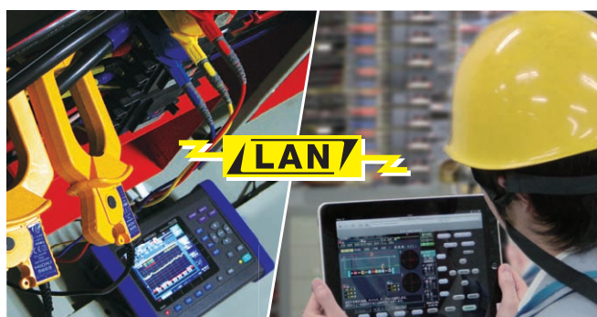
無線 LAN ルータを使用すれば、タブレット型 PC で現場から離れた遠隔操作も可能
